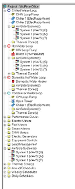
1) **Árvore de Componentes** (à esquerda). A imagem à esquerda mostra todos os maiores componentes da árvore de componentes para o módulo *Water-side*.
