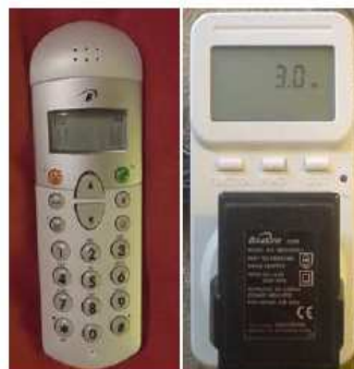
Figura 11.3 Este dispensável telefone sem fio e seu carregador consomem 3 W quando ligados na tomada. Isto é 0,07 kWh/d . Se a eletricidade custa 10p por kWh então um equipamento de 3 W custa £3 por ano.
