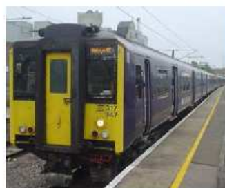
Figura 20.4. Este trem de 8 compartimentos, na sua velocidade máxima de 100 mph (161 km/h), consome 1,6 kWh por 100 passageiros-km, se lotado.
