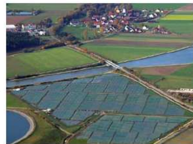
Figura 6.7. Um parque solar fotovoltaico: o Solarpark de 6,3 MW (pico) em Mühlhausen, Bavaria. Sua potência média por unidade de área é esperada para ser cerca de 5 W/m 2 . Foto de SunPower.
