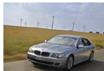
Figura 20.26. BMW Hydrogen 7. Consumo energético: 254 kWh por 100 km. Foto da BMW.
