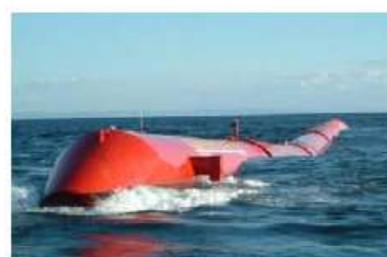
Figura 12.1. Um coletor de energia das ondas do tipo Pelamis é como uma serpente marinha com quatro seções. Sua face fica de frente para as ondas que chegam. As ondas fazem com que a serpente marinha oscile, e estes movimentos são resistidos por geradores hidráulicos. A potência de pico de uma serpente marinha é de 750 kW; nas melhores localidades do Oceano Atlântico, uma serpente marinha forneceria uma potência média de 300 kW. Foto da central de potência de onda do tipo Pelamis.
