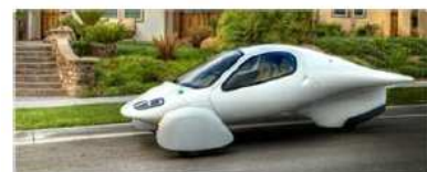
Figura 20.40. O Aptera. 6 kWh por 100 km. Foto da www.aptera.com.
