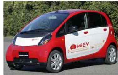
Figura 20.38. O iMiEV da Mitsubishi Motors Corporation. Ele possui um motor de 47 kW, pesa 1080 kg, e possui uma velocidade máxima de 130 km/h.
