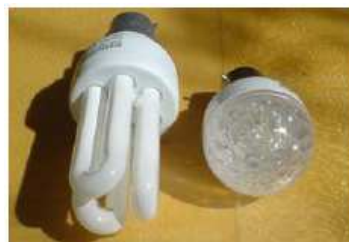
Figura 9.4. Phillips 11 W ao lado da lâmpada LED da Omicron de 1,3
