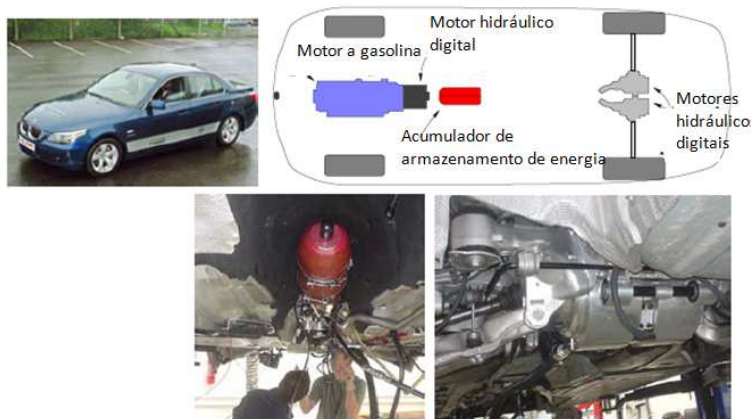
Figura 20.17. Uma BMW 530i modificada por Artemis Intelligent Power para utilizar hidráulica digital. Canto inferior esquerdo: Um acumulador de 6-litros (a vasilha vermelha), capaz de armazenar cerca de 0,05 kWh de energia em nitrogênio comprimido. Canto inferior direito: dois motores hidráulicos de 200 kW, um para cada roda traseira, os quais ambos aceleram e desaceleram o carro. O carro ainda é alimentado pelo seu motor de petróleo padrão de 190 kW, mas graças à transmissão hidráulica digital e à frenagem regenerativa, ele consome 30% menos combustível.
