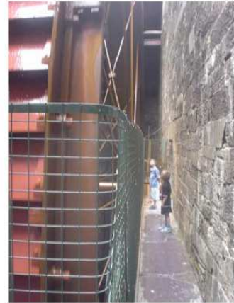
Figura 8.4. Uma roda hidráulica de 60 \text{ kW} .
