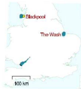
Figura 14.9. Duas lagoas de marés, cada uma com uma área de 400 \text{ km}^2 , uma em Blackpool, e outra em Wash. O estuário de Severn também está marcado para comparação.
